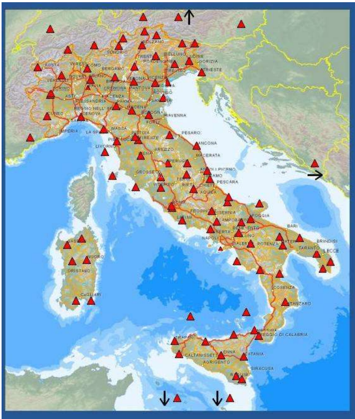
Fig. 1.56 – la nuova rete dinamica nazionale (RDN) realizzata da IGMI nel datum GRS80 - ETRS2000 (2008.0)
