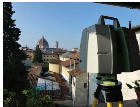
**FIGG.5-7** Acquisizioni laser scanner. Sono stati prevalentemente impiegati due scanner a differenza di fase, mentre uno a tempo di volo, con portata maggiore, è stato utilizzato per l'acquisizione dalle coperture dei fabbricati. Fig.5: Tribuna; fig.6: copertura di un braccio della Tribuna; fig.7: terrazza dell'Accademia di Belle Arti
